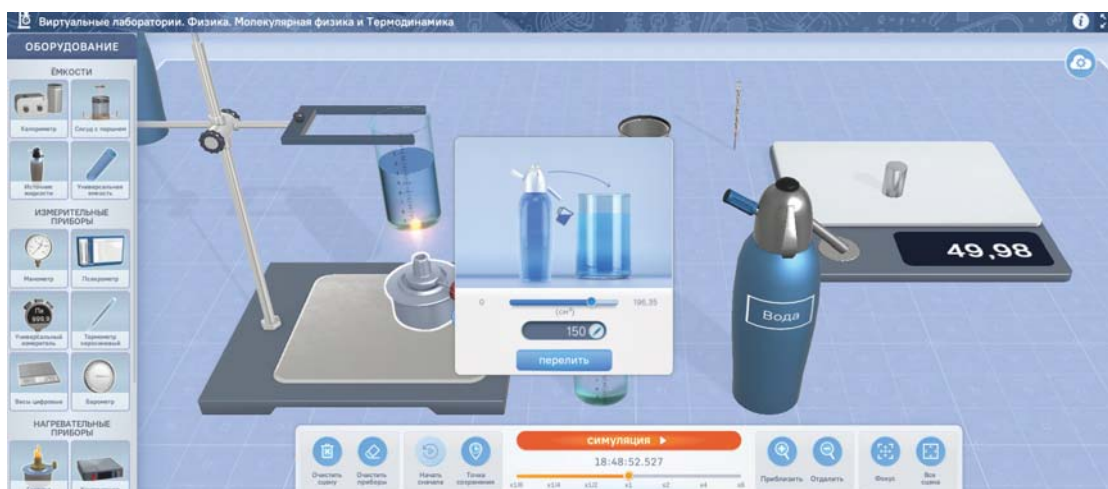
Рис. 4. Измерение удельной теплоёмкости вещества в виртуальной лаборатории
