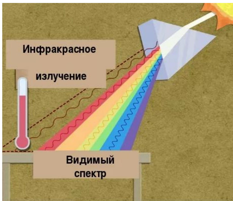
Рис. 1. Опыт по открытию инфракрасных лучей
