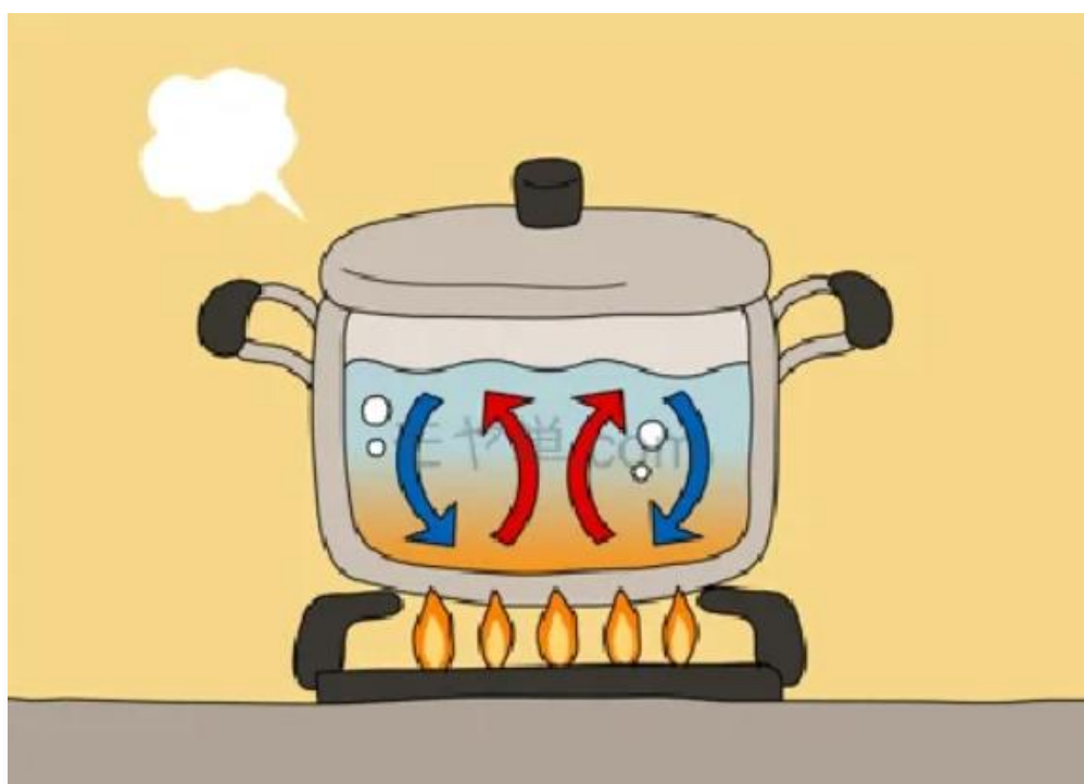
Рис. 1. Конвекционные потоки в жидкости
