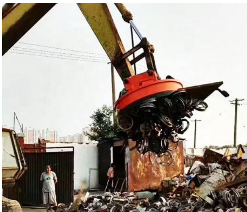
Рисунок 2. Электромагнит на свалке автомобильных деталей
